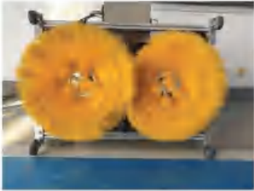
图6 幕墙机器人平台
