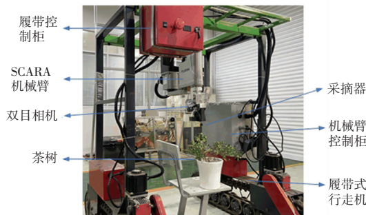
图1 采茶机器人结构图
