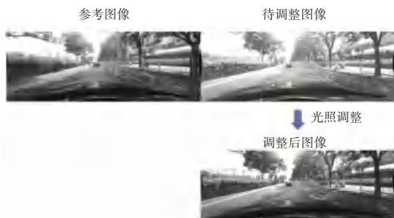
图2 基于直方图的图像亮度调整效果
