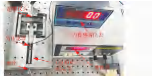
图 6 机构二刚度测试系统 Fig. 6 Stiffness test system of mechanism II
