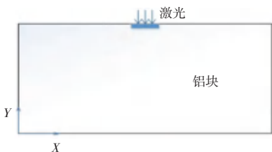
图1 脉冲激光作用在无缺陷材料表面
