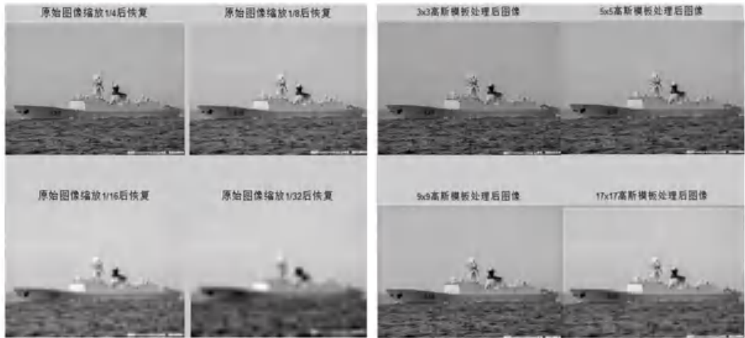
图4 图像缩放后再插值放大后的模糊效果、高斯模糊产生的模糊效果
