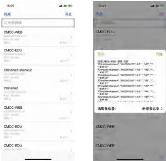
图1 AirPort工具采集Wi-Fi的RSSI
