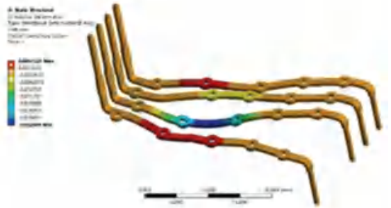
图 7 Z 方向变形云图
